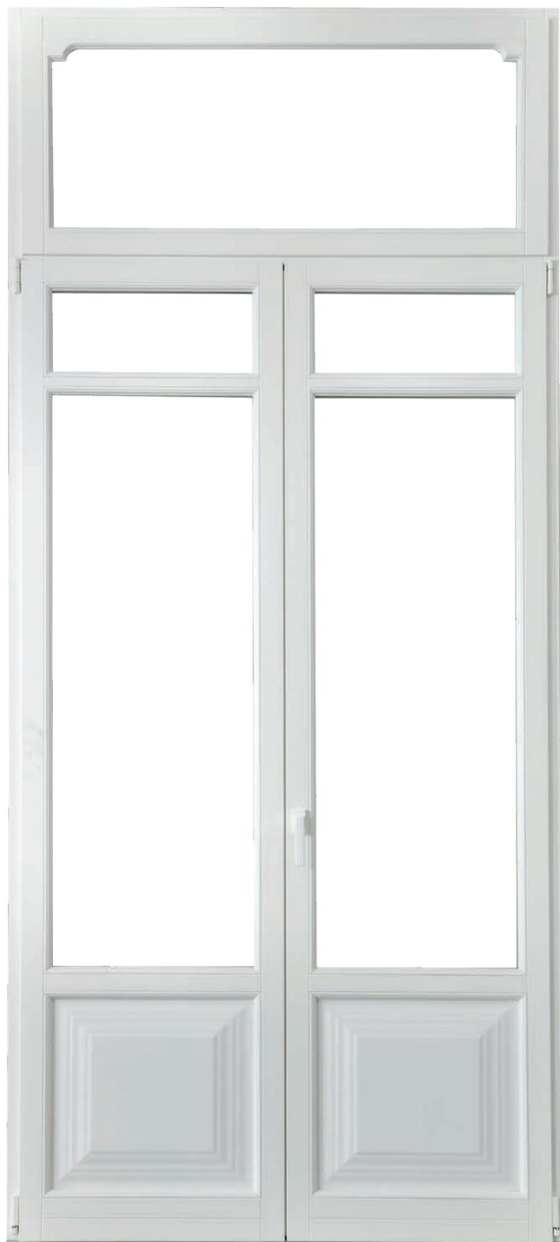
◀ In foto: vista frontale Prestante68 Plus in Red Grandis Lamellare laccato con poro a vista Optical White, profilo epoca. Traverso intermedio strutturale e centrale di sezione uguale al resto dell'anta; traverso intermedio strutturale e superiore di sezione ridotta. Bugna inferiore stile epoca abbinata al profilo reggibugna e fermavetro
